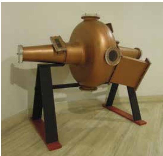
Cavità Accelerante di DAFNE (prototipo in scala 1:1)
