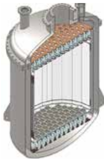
Fig.2. Vista del criostato (esterno) e della TPC (interno).
