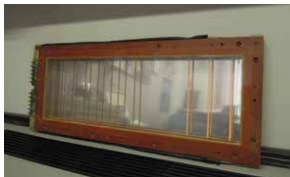
Camera a fili per il rivelatore di vertice dell'esperimento FRAMM
