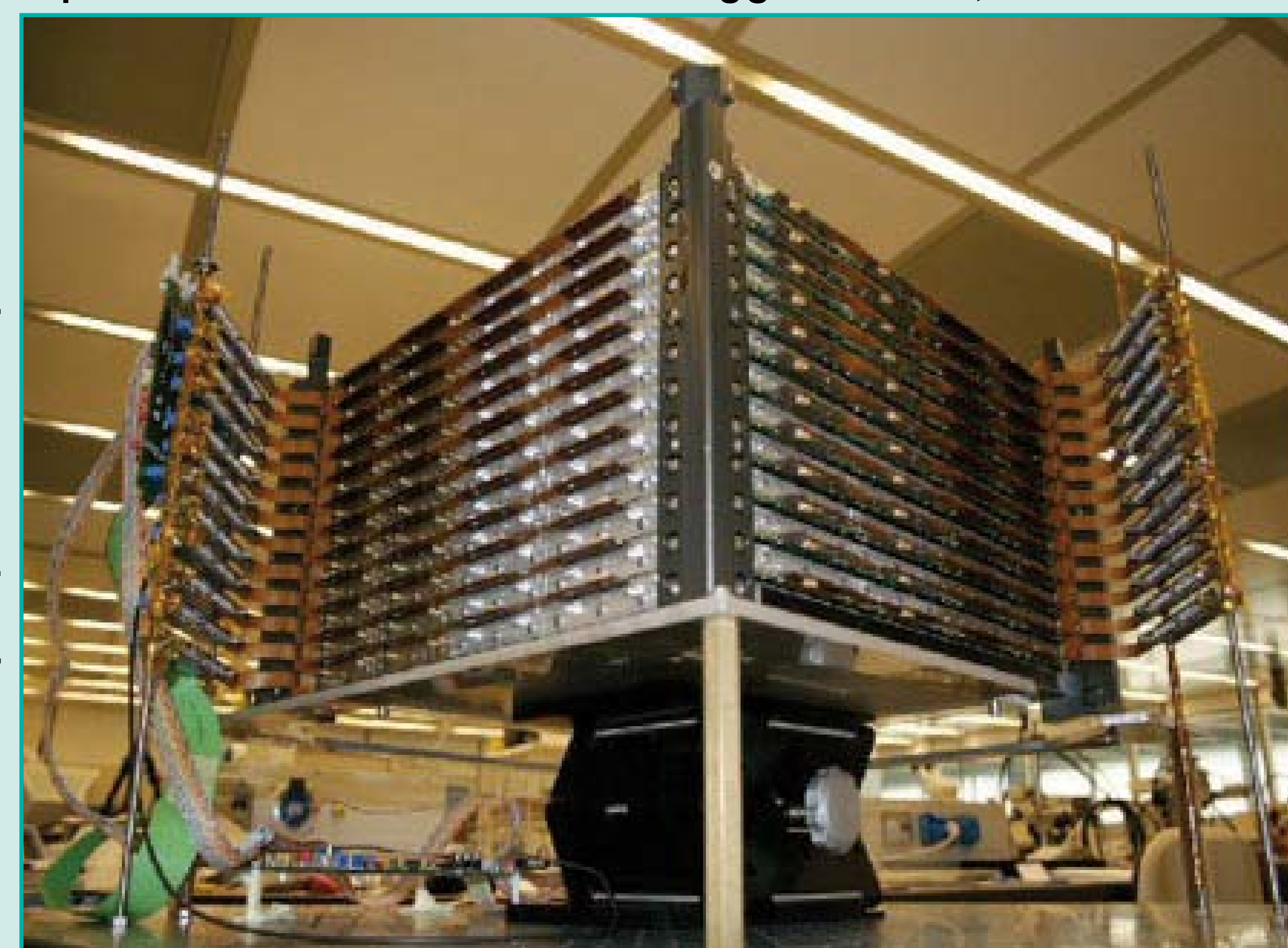
Foto: Il tracciatore al silicio - tungsteno del satellite AGILE: realizzato a cura della sezione di Trieste dell'INFN presso la Mipot di Cormons.
