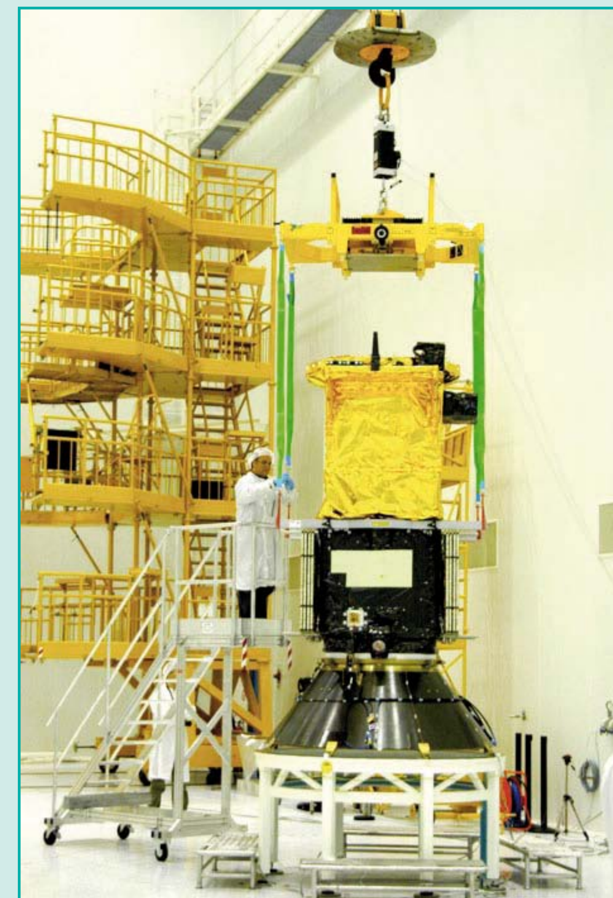
Il satellite Giove-B accoppiato al "Payload adaptor" prima di essere installato all'interno della Soyuz.
